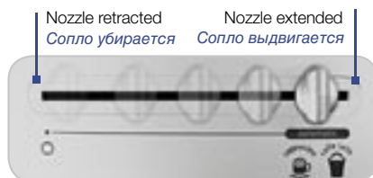
Nozzle retracted Сопло убирается Nozzle extended Сопло выдвигается Lowering device for nozzle Опускатель парового сопла
